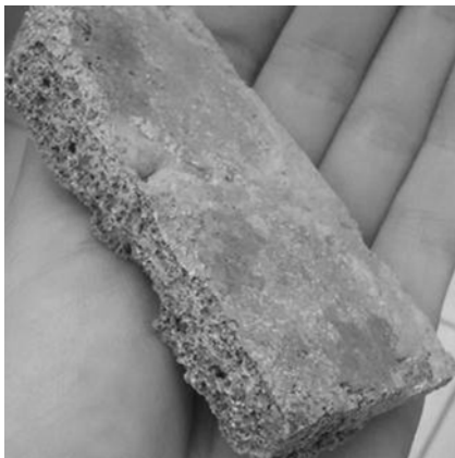
Рис.2. Структура пористости полученного материала
